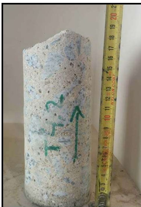
T4.1 Ø75 - MUR PRIMERA PLANTA
