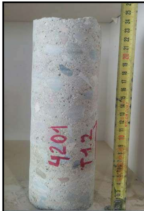
T1.2 Ø75 - PILAR SEGONA PLANTA
