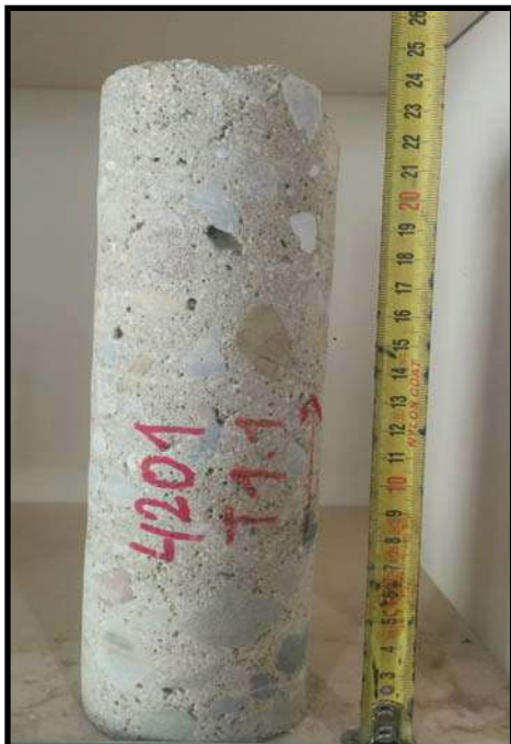
T1.1 Ø75 - PILAR SEGONA PLANTA
