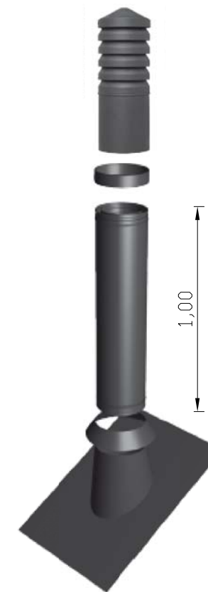
Detall kit de remat per conductes en la sortida a coberta, de Ø150, color Ral a definir per la D.F., acabat amb lames circulars exterior
