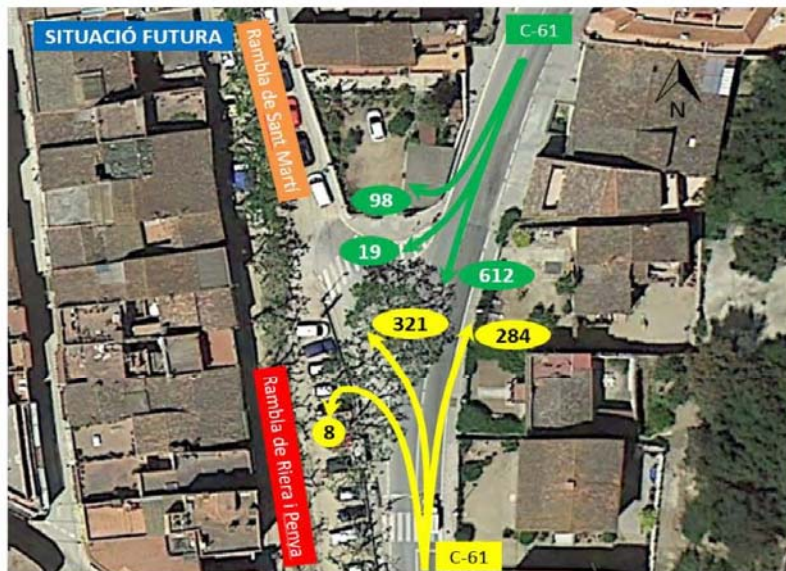
Imatge 3: Nombre de vehicles que es preveu que realitzin cada moviment durant l'hora punta del matí amb la implantació dels canvis exposats (Font: Elaboració pròpia a partir de Google Earth i dels treballs de camp del 7 d'octubre de 2015)
