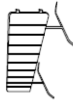
TANCA DE CONTENCIÓ DE VIANANTS
